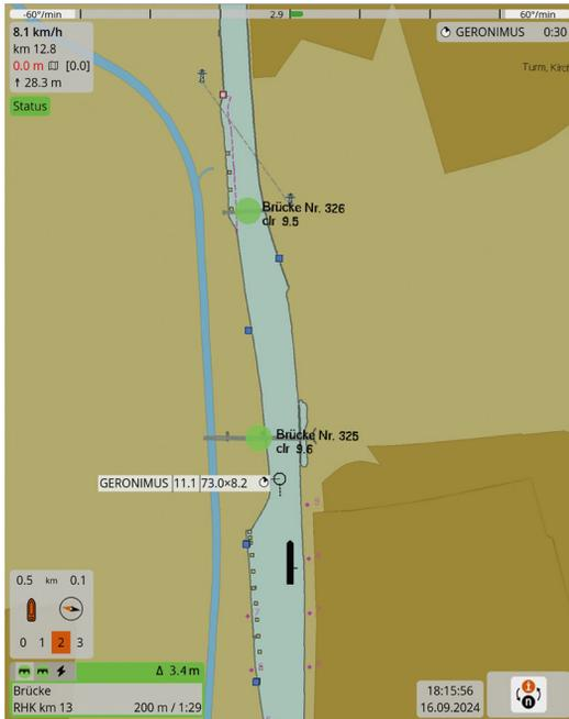
Der **argoBridgePilot** unterstützt Sie bei der Fahrt, indem er dank hochgenauem RTK-GNSS kontinuierlich die Höhe des Steuerhausdachs und anderer Aufbauten überwacht und sie mit der von Argonav vermessenen Höhe der nächsten Brücken vergleicht. Diese Überprüfung kann bereits weit im Vorfeld erfolgen und braucht keine Sichtverbindung. In dieser Messung sind alle Effekte, die vom Wasserstand oder der aktuellen Einsenkung des Schiffs herrühren, bereits enthalten.
